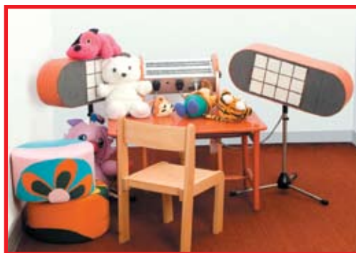
Fot. 05 Zestaw do badań behawioralną audiometrią obserwacyjną
